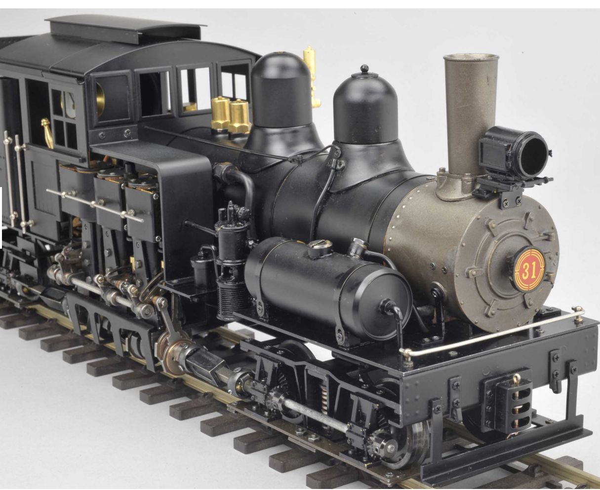
3気筒ステーブンスン弁装置エンジン Three-cylinder with Stephenson valve gear
