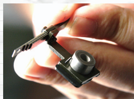
▲【写真7】軸箱は、軸受パーツに差し込むガイド線を軽く曲げて仮固定しておく。
