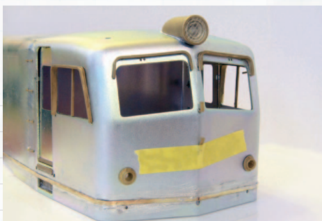
▲【写真9】前面フックの取付。塗り分けを考慮して、裾部の3ヶ所のフックはまだ取り付けない。…ということは、あの塗装ですね？
