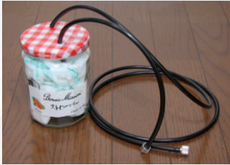
◀【写真9】手作りの水分除去タンク。リークが大きくもう一工夫必要だが、今回はこれを使用。
