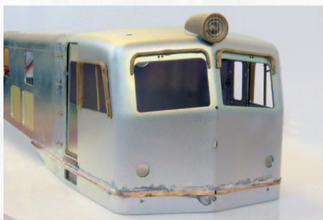
▲【写真8】車体裾に腹帯をハンダ付け。板厚のあるボディのため、コテの温度を高めに設定して作業。まずは問題なく取付できた。
