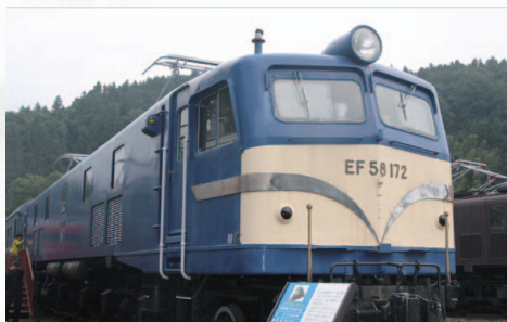
▲【写真14】手すり形状は実物の保存機も参考とした。写真は172号機で、手すりが白く塗られているので形状がよくわかる。
