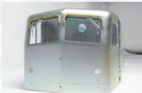
▲【写真4】正面窓のフィットチェック。窓枠、ワイパー、ボディ、窓ガラスのすべてをフィットさせねばならず、調整は少々手強い。
