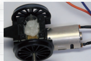
▲【写真10】グリスは一旦塗布していたものの、経験者からのアドバイスによりたっぷりめに充填し直した。
