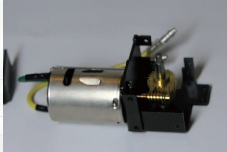
▲【写真4】ギアケースプレート①にモーターを固定、カウンターギアシャフトを取り付けたギアケースプレート②(2個一組のうち片側のみ)を組み合わせたところ。
