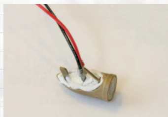
▲【写真4】ヘッドライトに「ひつつき虫」でLEDを固定。断線防止も兼ねてたっぷり充填。
