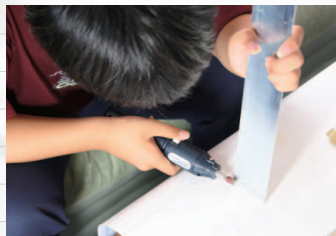
▲【写真11】裏側は、組み上げた時に干渉する部分をリユーターで平らに整形。
