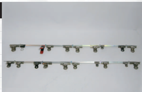
▲【写真6】歩み板と雨樋の接着。非常に長い部材なので、ズレなどがないよう注意が必要。
