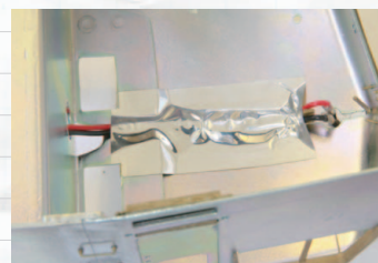
▲【写真6】室内のヘッドライトへの配線はアルミ蒸着ポリイミドテープで固定。
