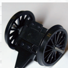
◀【写真12】モーター・ギア関係がない分組立はシンプル。メインのプレートに動輪を組み付け、蓋状の車軸ホルダーを被せて固定する形となる。
