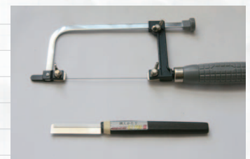
▲【写真13】素材はt0.3真鍮板を選択。切り抜きには金属用の刃を付けた糸ノコ(上)と、薄刃の手引きノコを使用した。
