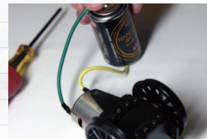
▲【写真9】組み上がったギアボックスの動作確認。単一電池を直接繋げて行なった。
