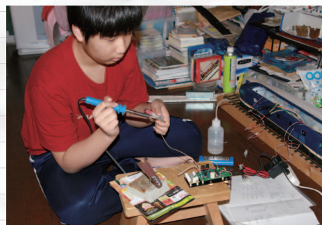
▲【写真6】スピードコントローラーと電源ラインはハンダ付けで結線。遥斗君もコテさばきが板についてきた!?
