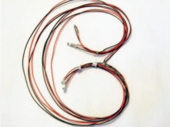
▲【写真2】LEDのハーネスにマイクロコネクタを装着。
