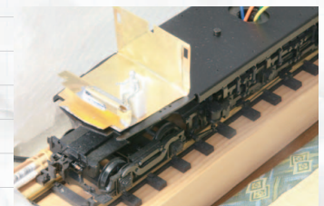
▲【写真17】床板とのマッチングを見る。最終的にはこの位置に両面テープで固定する予定。人形は高さなどの位置検討用に仮に置いたもの。
