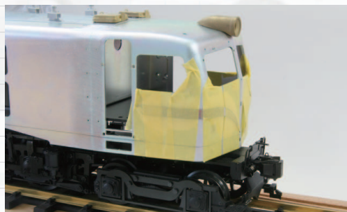
◀【写真5】飾り帯の型付け。仮固定にはマスキングテープを使用、テープを上下で裏側へ折り返して剥がれを防ぐ。ボディ組立までこのまま保持。
