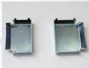
▲【写真12】ベンチレーターベース。コーナー部のスキ間を裏側からプラ板で塞ぐ。
