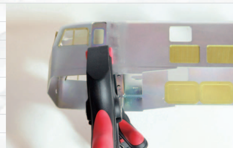
▲【写真12】やはり硬化まではクリップで固定しておく。先に継ぎ目処理をした部分の様子もわかる。
