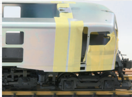
▲【写真8】乗務員扉後部にある外板の継ぎ目を埋める。ここでは瞬間接着剤を使用、周囲は部品取付穴に影響を与えないようマスキング。
