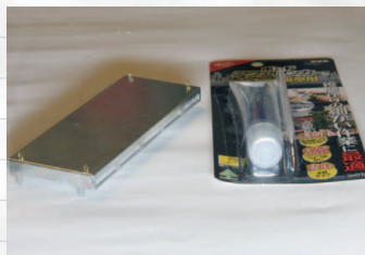
◀【写真14】天窓ベースの内側にアクリルプレートを接着。接着剤は糸を引かず白濁しないコニシの「アクアリンカー」。
