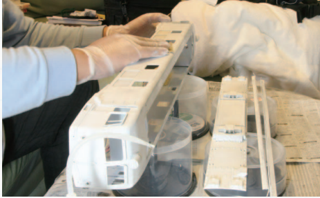
▲【写真7】前処理の仕上げとして、#1000の耐水ペーパーで水砥ぎしてきれいな平面を出しておく。
