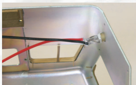
▲【写真7】テールライトをボディへ取付。LEDの組込は塗装後でもできることがわかったので、今回はLEDは固定しないこととした。
