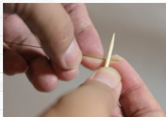
▲【写真8】吊りフックとなるφ0.4真鍮線をU字型に曲げる。ガイドは爪楊枝。
