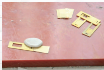
▲【写真15】背面両脇の仕切り扉は、エコーモデルの16番電車用貫通扉(#2044)の下部に真鍮板を継ぎ足して製作。
