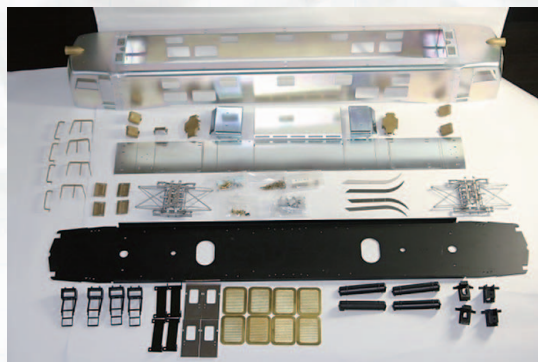
◀【写真4】ボディ関係の全パーツ。鉄製のボディ本体はあらかじめ箱になっているが、細かなディテールパーツも少なくない。
