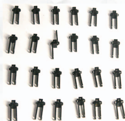
▲【写真5】24組完成したイコライザーリンク。
