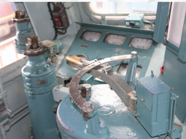
▲【写真2】こちらは碓氷峠鉄道文化むらに保存されている172号機の運転台。ここからノッチ、ブレーキなど運転用機器の詳細を確認。
