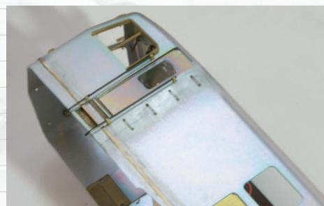
▲【写真13】取り付けた手すりの状態を見る。下部の曲げは下廻りとの干渉を考慮して若干緩めとした。
