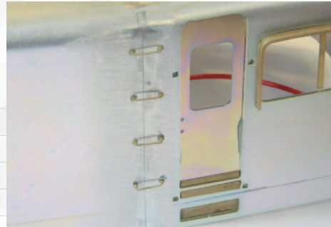
▲【写真10】細い昇降ハシゴは変型していたので、整形して取付。実機でよく見られたハシゴ部の彫り込みは、本製品では側板と前頭部の継ぎ目にあたるため加工が難しく、今回は断念。
