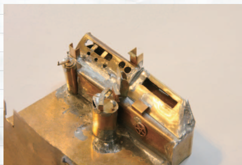
▲【写真5・6】運転台背面の仕切板や、運転台機器類の様子を見る。作例では真鍮の板材・線材を主体にハンダ付けで組み立てているが、金属素材に囚われる必要はなく、自分のテクニックや労力と相談しながら柔軟な発想で選択したい。
