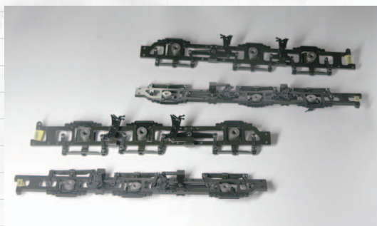
▲【写真8】イコライザーの可動部を組み立て終わった状態。
