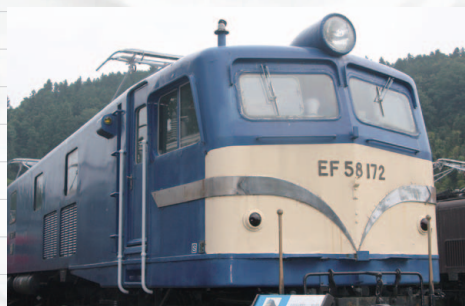
▲【写真2】飾り帯は表情を決める重要なパーツ。本機の車体は日車製なので、帯の継ぎ目がくの字型だ(日立製・三菱製は直線)。
